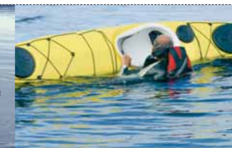
Selv fylt med vann flyter kajakken høyt takket være de vannrette skottene. Vi prøvde både rullen og åreposeredning uten problemer.
